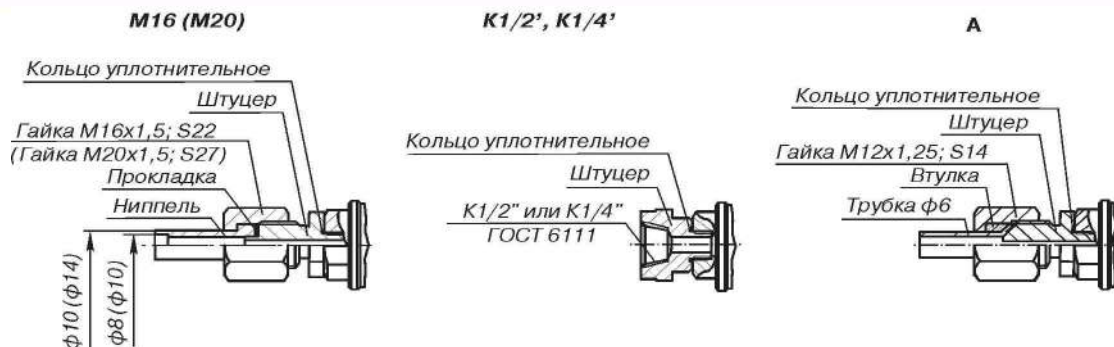
Рис.20. Датчики Метран-100 мод.1131, 1141, 1231, 1241, 1331, 1341. Установка монтажных деталей (остальное см.рис.19).
